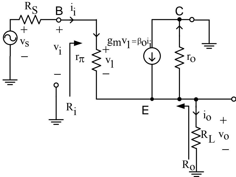
$$i_i + \beta_o i_i = \frac{v_o}{R_L} + \frac{v_o}{r_o}$$
