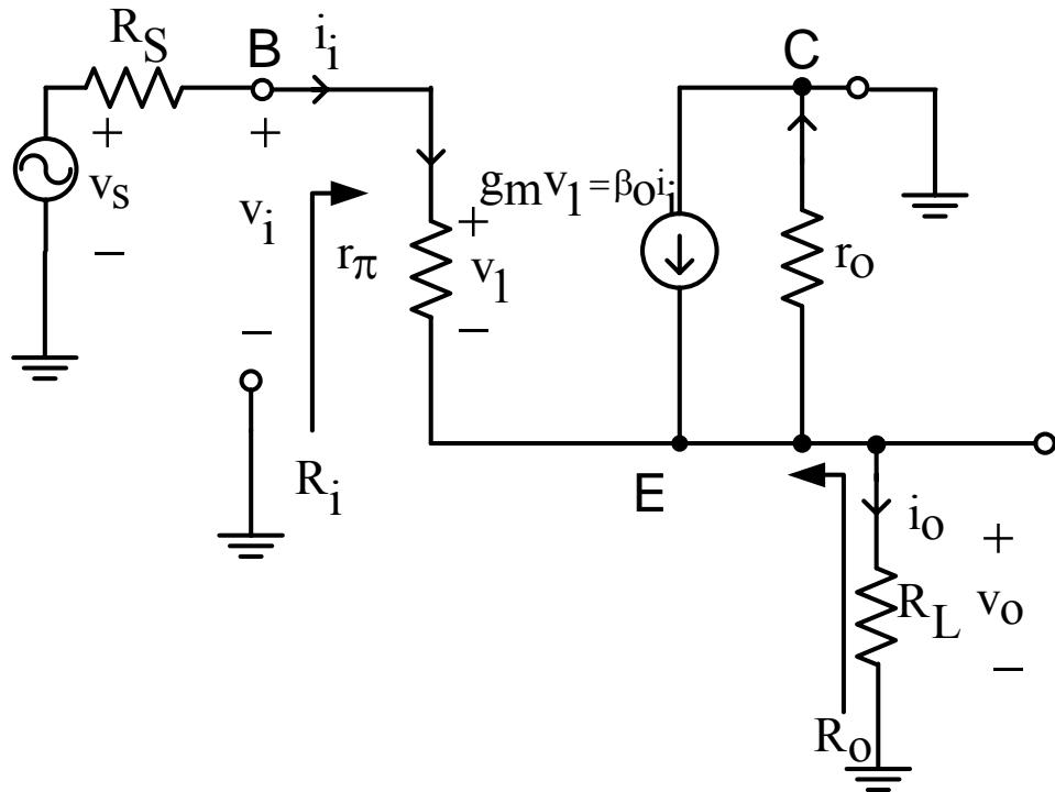
$$v_S = i_i (R_S + r_\pi) + v_o$$
